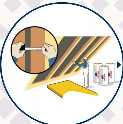
Změříme si šířku rozteče krovkí. Pro zajištění lepší fixace minerální izolace URSA SF 35 PLUS mezi krovkami přidáme k naměřenému rozmezru ještě 1,5–2 cm.
