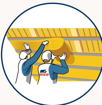
Aplikace minerální izolace URSA DF 32H do příčného kovového roštu upevněného na krovky, jako druhá tepelně izolační vrstva. Izolaci vkládáme lehkým vtláčením po celé délce roštu. Dbejte stejných zásad jako v předešlém aplikačním kroku.
